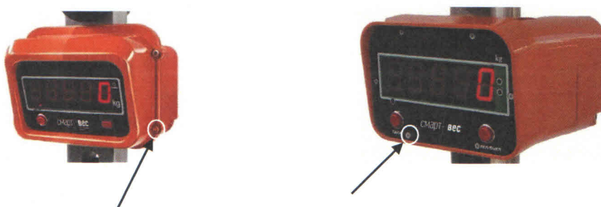
Рисунок 6 - Схема пломбировки модификаций весов ВЭК/3, ВЭК/4
